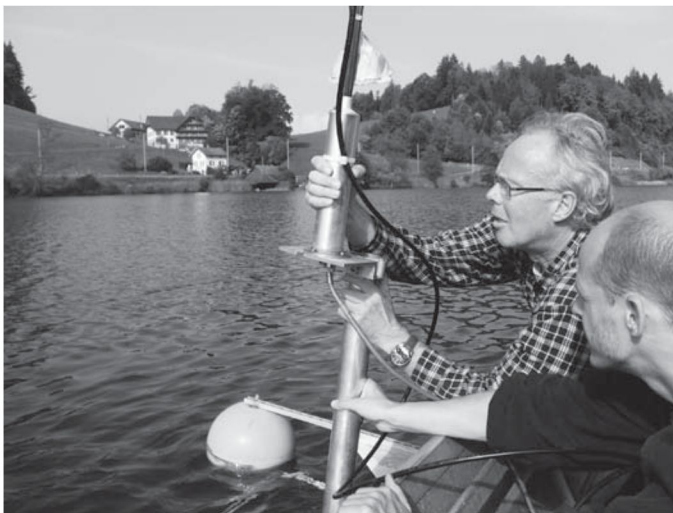
Die Messgeräte auf der Schwimmboje werden genau geprüft, bevor Kabel und Luftschnur zum Ufer beim Fährihaus ausgelegt werden.
